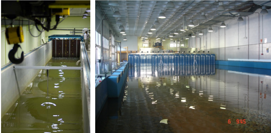
Figura 7-7. Pala generadora de oleaje. Condición de contorno tipo natural o de Neumann.
