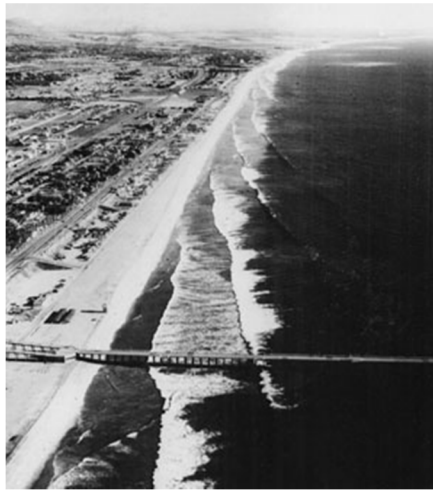
Figura 7-21. Refracción de oleaje en playa de alineación recta
