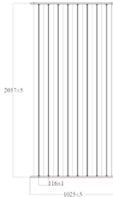
Figura 1-17 Esquema del captador solar T8S
