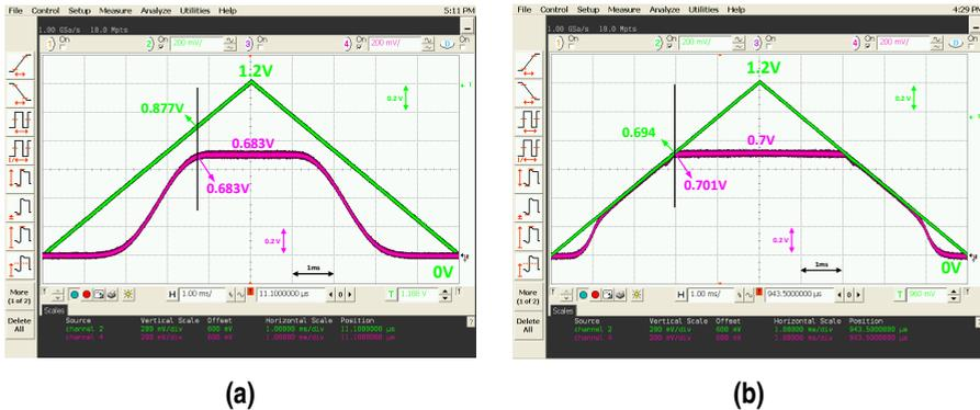
**Figura 3.19** Respuesta estática del regulador propuesto para (a)  $C_{OUT} = 100\text{pF}$  e  $I_{LOAD} = 100\text{mA}$  y (b)  $C_{OUT} = 100\text{pF}$  e  $I_{LOAD} = 0.1\text{mA}$ .
