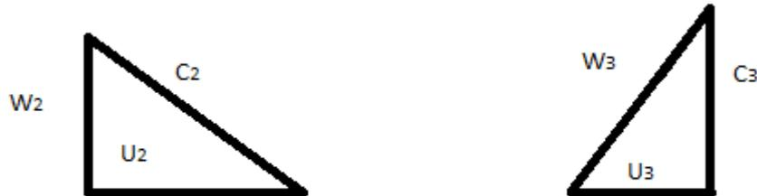
Figura 4.4c Triángulos de velocidades
