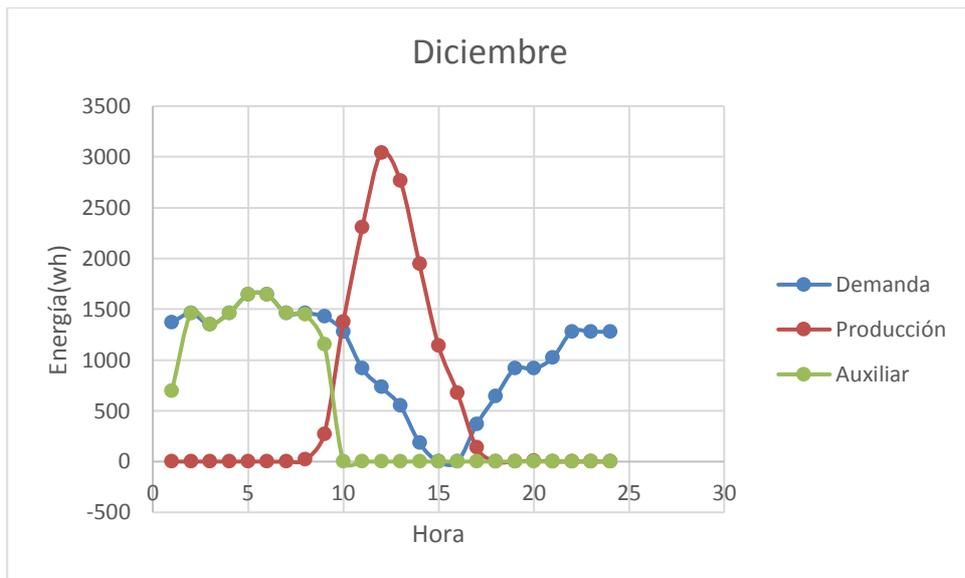
Figura 3.1.4h Comportamiento de la bomba de calor en Diciembre
