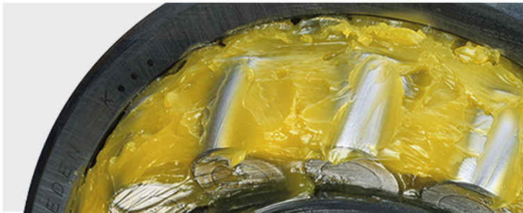
Figura III.3: grasa lubricante sobre rodamientos.
