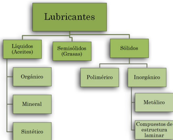
Figura III.2: clasificación de tipos de lubricantes.
