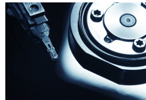
c) superficie de disco duro protegida con DLC.
