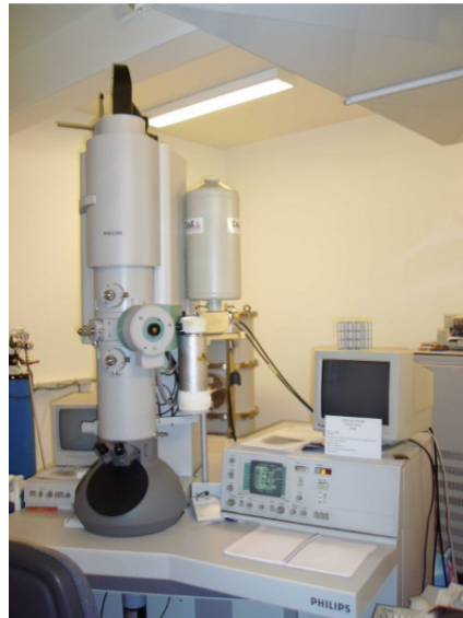
Figura II.23: esquema general y fotografía de un microscopio electrónico de transmisión.
