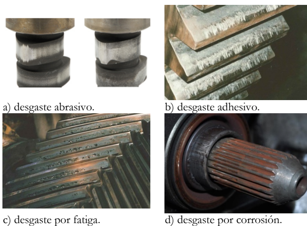
Figura II.46: ejemplos de desgaste.
