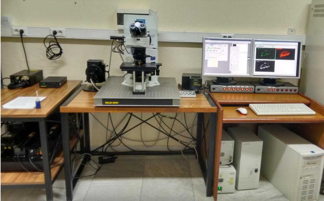
**Figura 25. Microscopio confocal Olympus FV-1000 utilizado para la adquisición de imágenes.** A la izquierda de la imagen se pueden observar los láser de los que se compone el microscopio (láser de argón y rojo en la parte superior, y láser verde en la parte inferior).
