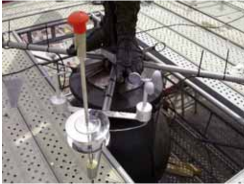
④ Anemómetro y veleta sobre la estructura del pararrayos / FUENTE: GRUPO DE ESTRUCTURAS, UNIVERSIDAD DE SEVILLA
