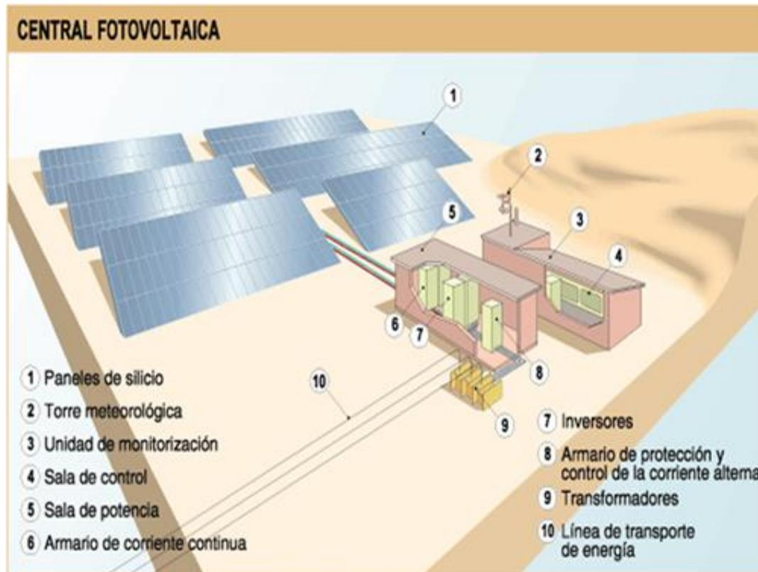
**Gráfico 6** Componentes de una planta fotovoltaica
