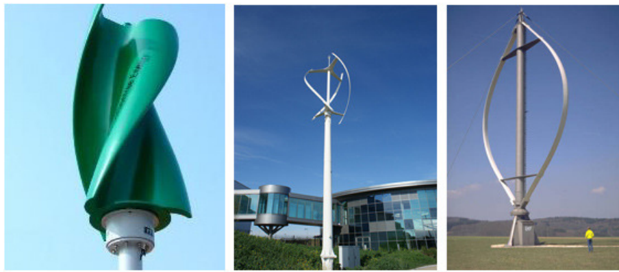
Figura 2.4. Aerogeneradores de eje vertical.
