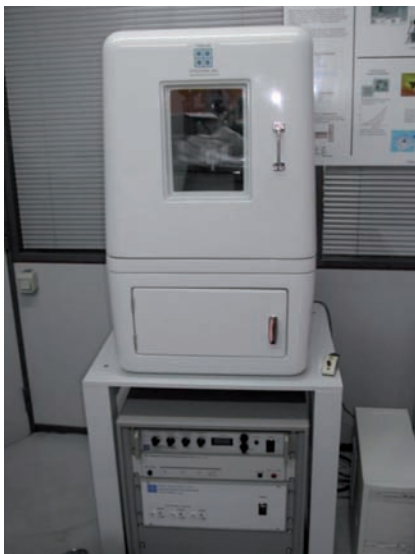
Figura 7. Equipo de nanoindentación.
