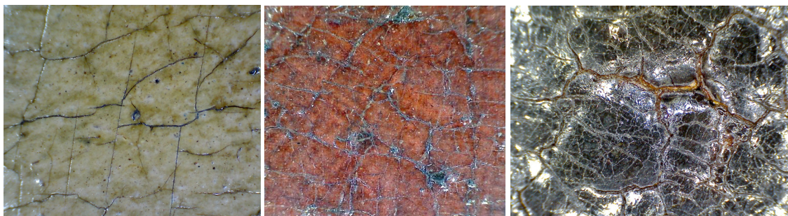
Figuras 6, 7 y 8. Detalles macrofotográficos de la capa pictórica: blanco de plomo, bermellón y espalto.
