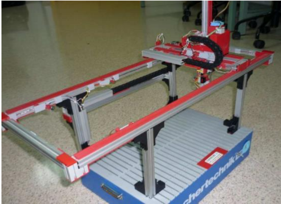
Ilustración 25 Fotográfica puente grúa
