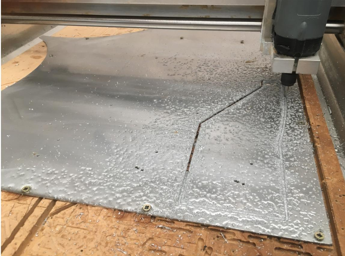
Ilustración 74 Corte de placas aluminio
