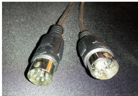
Figura 2-5. Conectores DIN de 5 pines MIDI
