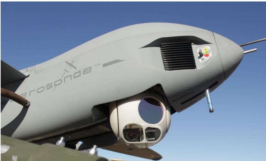
**Figura B.1** UAV Aerosonde con gimbal I.
