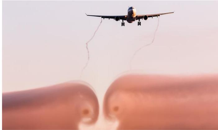
*Figura 1.3: Visualización de vórtices de punta de ala en el avión A330*
