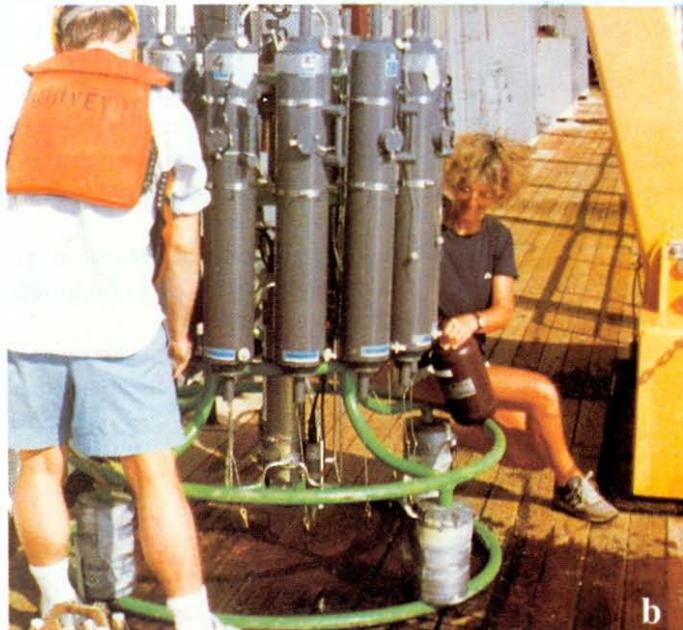
Fig. 2: a- maniobra de arriado de la roseta; b- toma de muestras a bordo del buque.
