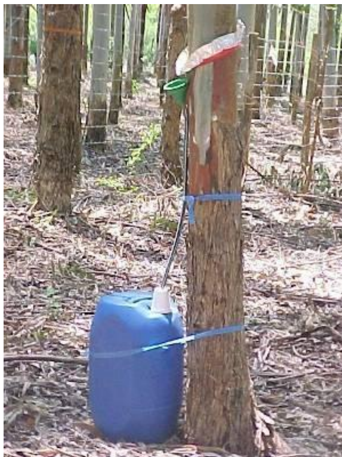
Figura 2.4: Detalle de un anillo colector de flujo caular. El anillo está confeccionado con una faja de aluminio corrugado que abraza el árbol en forma oblicua con el lado de unión en la parte más alta.
