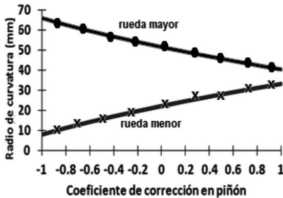
Figura 11. Radios de curvatura de dientes en rueda (superior) y piñón (inferior). Distancia entre ejes a_w = 216 mm, razón de engranaje u = 1,88 , piñón con 25 dientes y módulo m = 6 .
