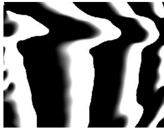
Figura 8. Parte imaginaria de la transformada inversa de Fourier: fase envuelta. Fuente: Elaboración propia.
