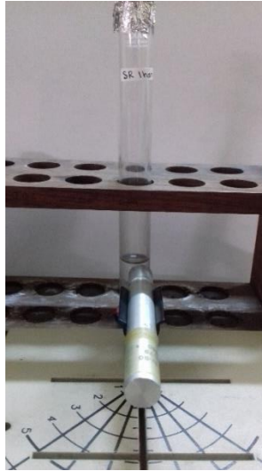
Gambar 20. Radiasi menggunakan Srontium-90.
