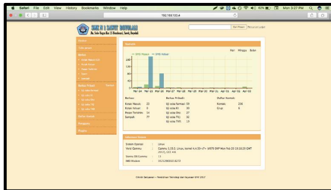
Gambar 34. Implementasi Web Server pada Raspberry Pi
