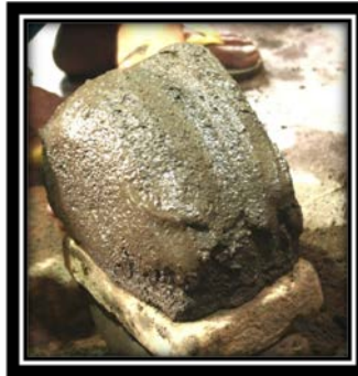
Gambar LVII: Membuat jalan angin pada cetakan (Dokumentasi: Joko Nurjoyo, Juni 2014)
