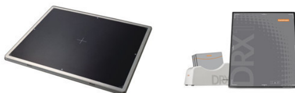
Рис. 1. Примеры детекторов: Vieworks Vivix-S и Carestream DRX-1
