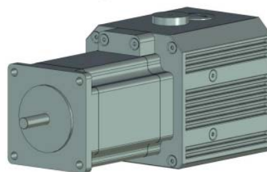
Рис. 3. 3D-модель серводвигателя СПШ20-23017
