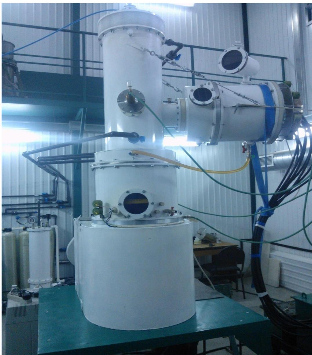
Рисунок 1 – Импульсный электронный ускоритель ТИУ-500
