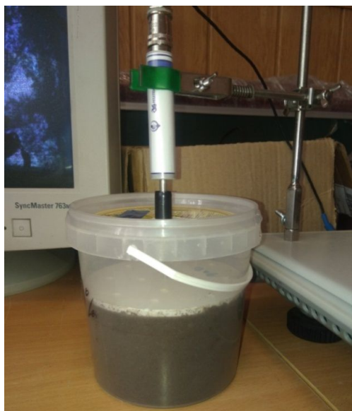
Рисунок 5 – Электронный цифровой датчик влажности
