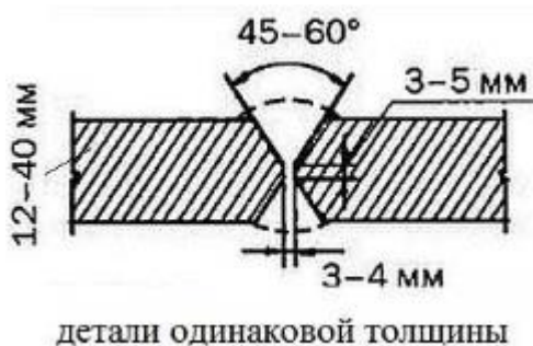
Рис.4.2 Скос разделки кромок
