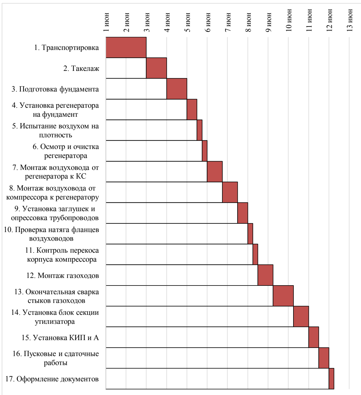
Рисунок 26 – Линейный календарный график монтажа регенератора
