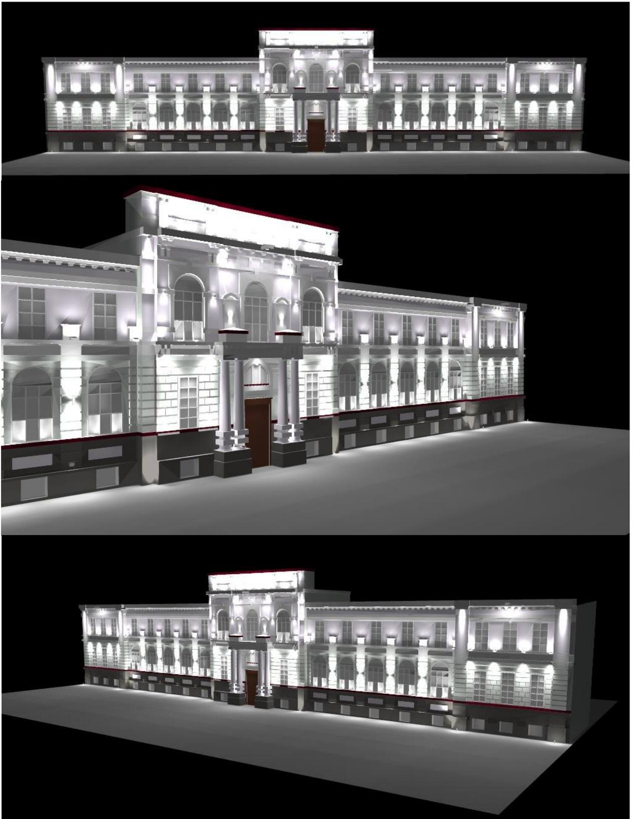
Рисунок 3.11 – Проект освещения корпуса №3 ТПУ, реализованного в программе DIALux
