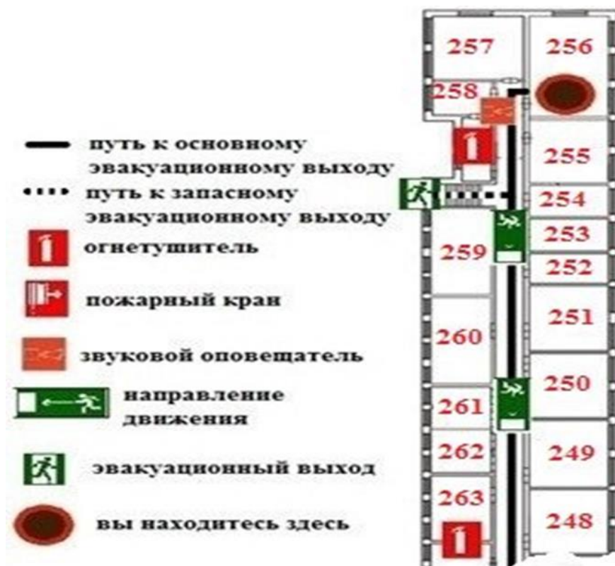
Рис.4. План эвакуации из учебной лаборатории 256 корпуса №8 ТПУ при возникновении пожара
