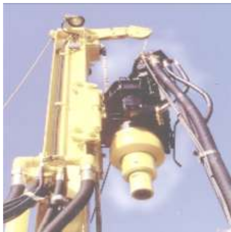
Рисунок 2.5 – Вращательная установка Explorac R50
