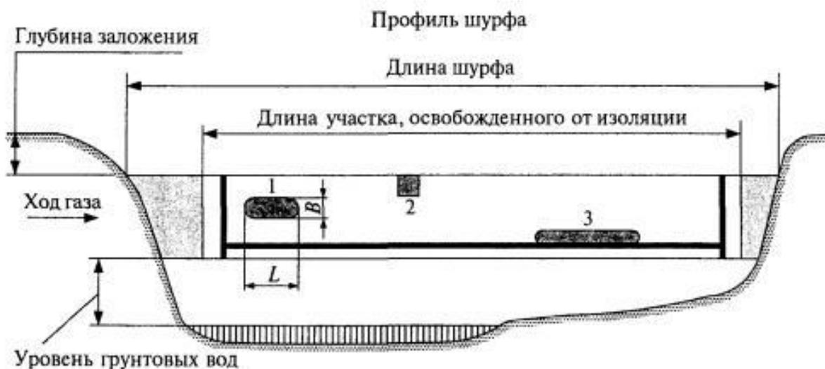
Рисунок 1 – Схема шурфа
