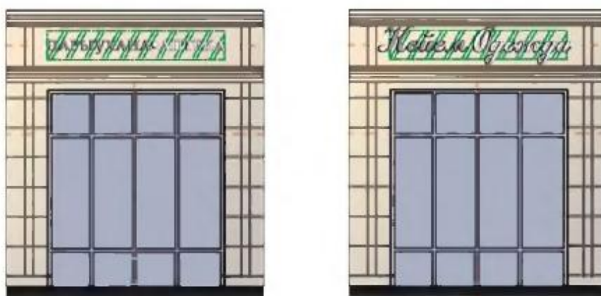
Рисунок 22 - За границы зеленой зоны могут выходить прописные буквы, а также выносные элементы строчных букв
