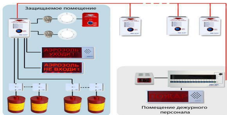
Рисунок 5 – Принцип действия установок аэрозольного пожаротушения
