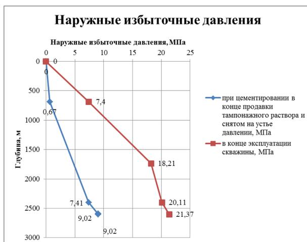
Рисунок 6 – Наружные избыточные давления
