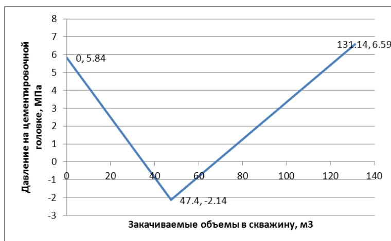
Рисунок 2.5.2.1 - График изменения давления на цементировочной головке
