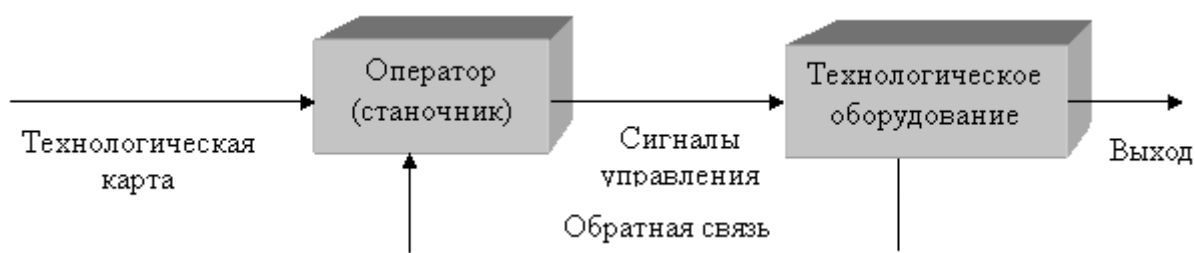
Рисунок 2.1. Неавтоматическое (ручное) управление
