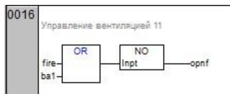
Рисунок 5.34 – Закрытие противопожарных заслонок
