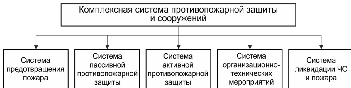
Рисунок 7- Комплексная система противопожарной защиты зданий
