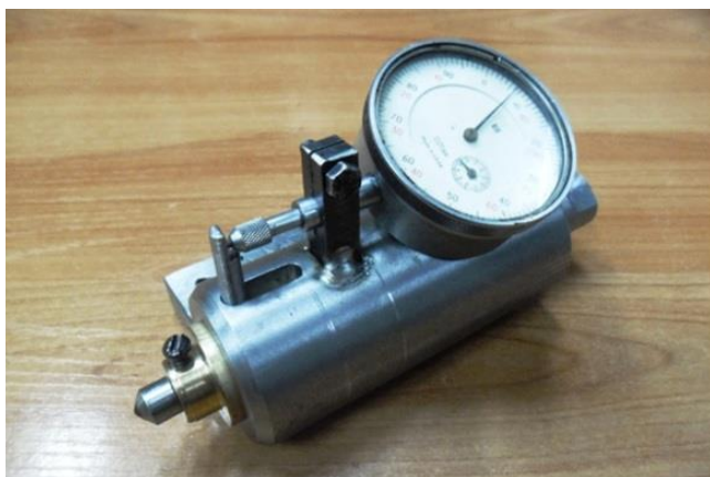
Рисунок 1.4 Оправка с винтовой пружиной: 1 – регулировочный винт; 2 – винтовая пружина; 3 – индикатор часового типа; 4 – индентор.
