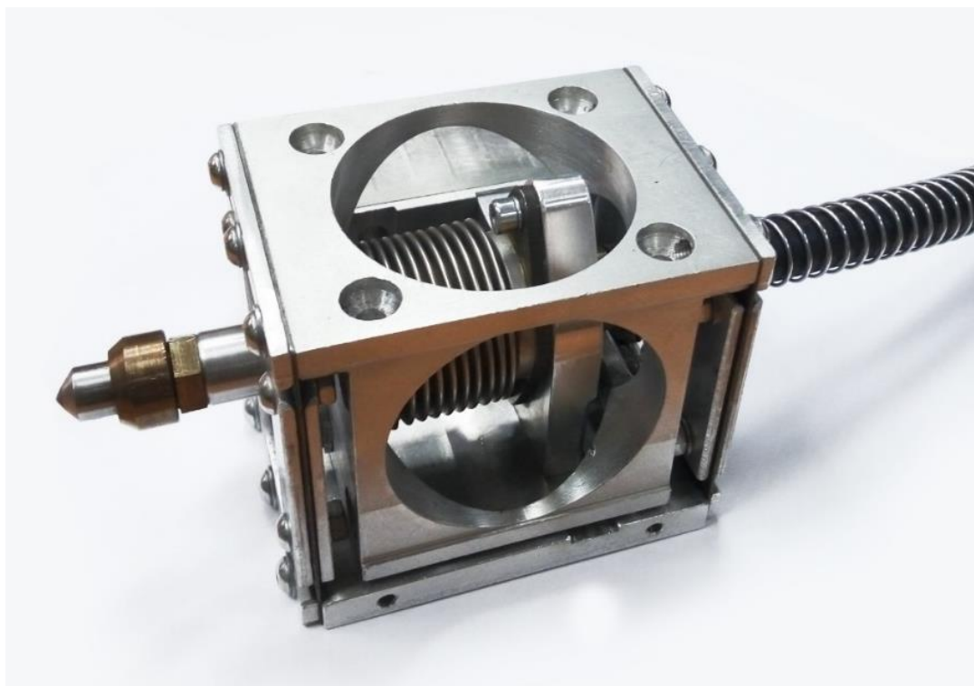
Рисунок 1.12 Оправка пневматическая с ресивером с параллелограммной установкой индентора на 4-х плоских стойках
