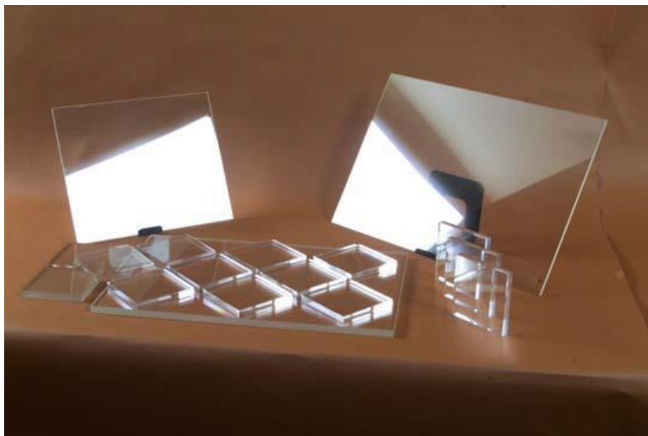
Рисунок 6 - Прозрачная бронекерамика AlON
