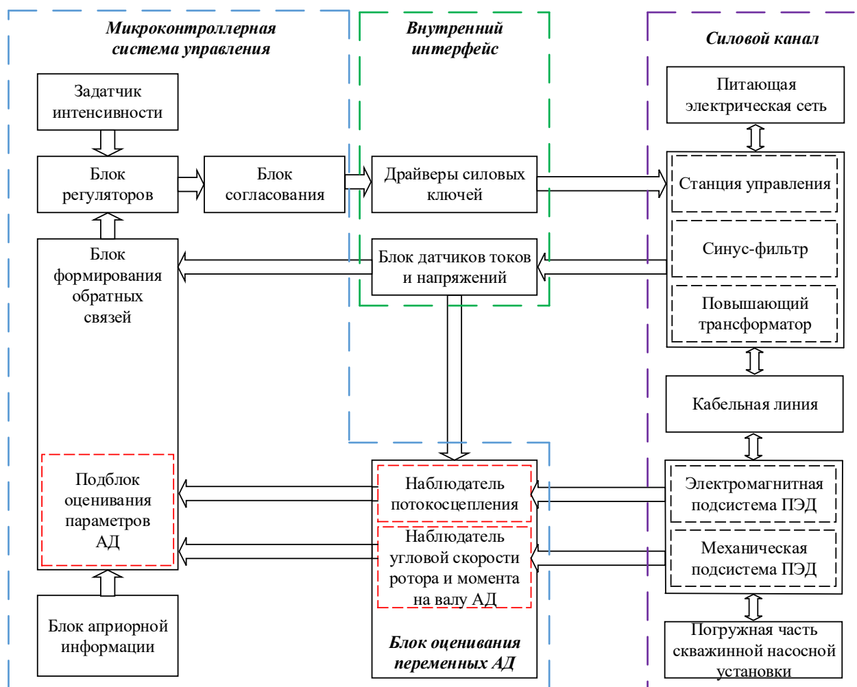
Рисунок 1.3.2.1. Электромеханическая система с регулируемым асинхронным двигателем и косвенным методом измерения переменных состояния
