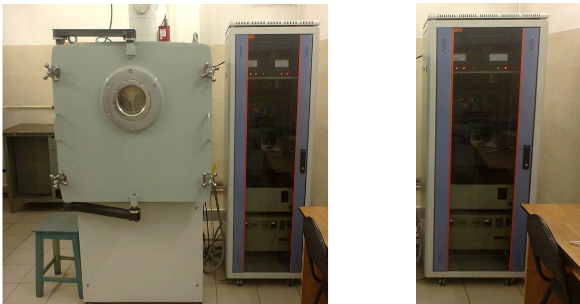
Рисунок 2.13 - Электронная пушка и стенд управления откачки камеры Внутри камеры находится манипулятор перемещения с установленной планшайбой и дополнительными приспособлениями (Рисунок 2.14).
