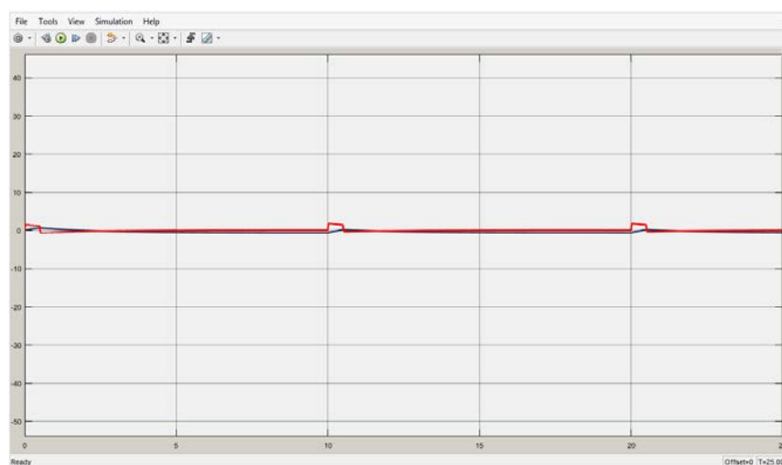
Рисунок 1.10 – График зависимости угла поворота и скорости вращения ЭД от времени при импульсном законе нагружения (красный – скорость, синий – угол)
