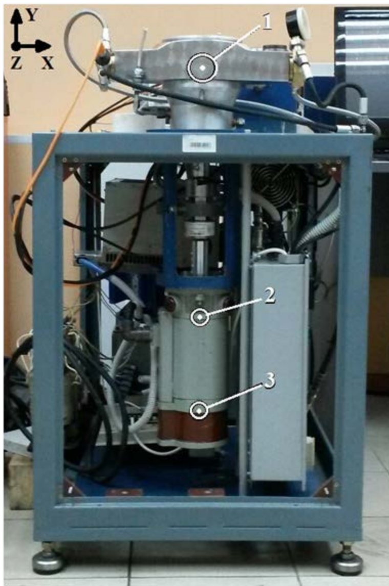
Рисунок 1.27 – Точки измерения вибраций на узле скоростного динамического нагружения.
