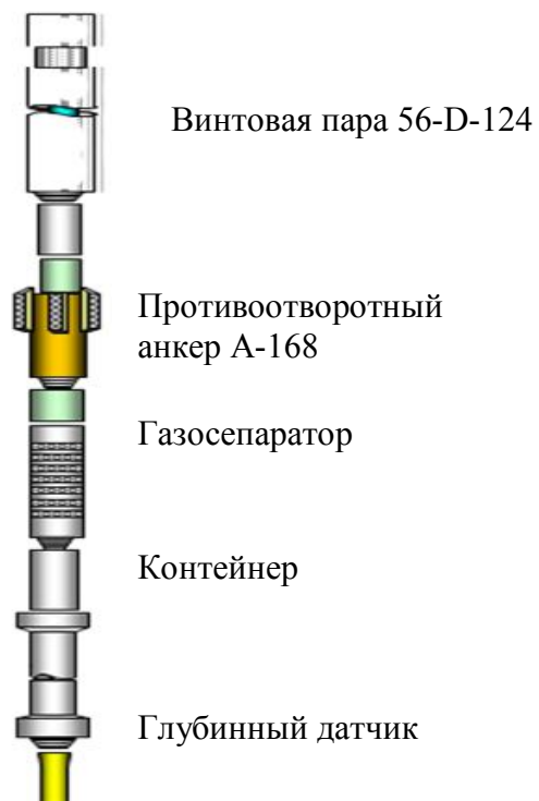
Рис. 2.2 –Подземное оборудование УШВН
