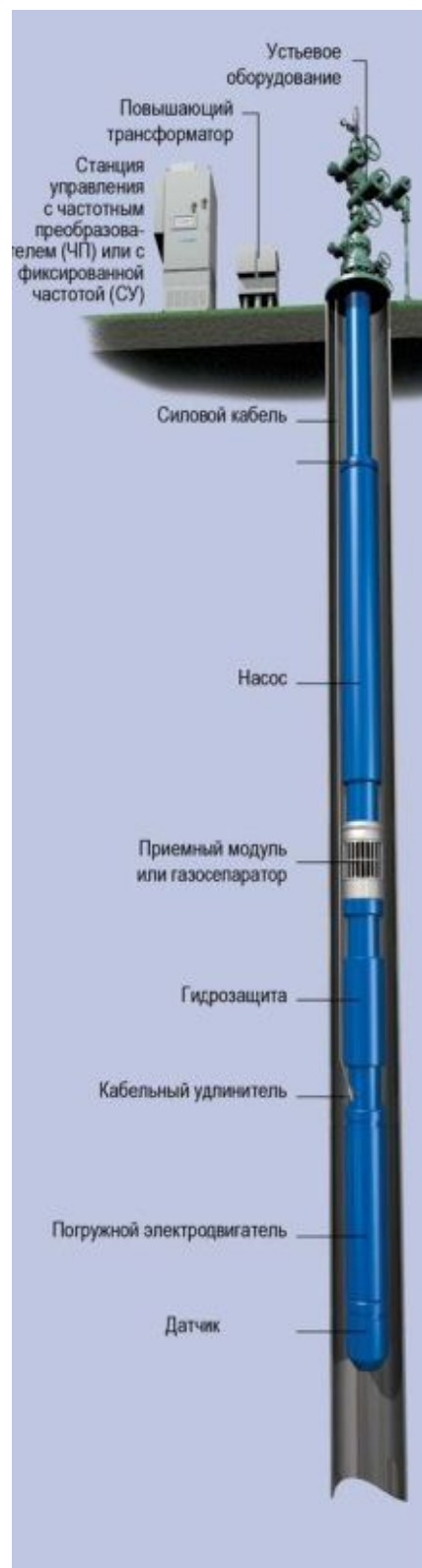
Рис. 2.3 – Схема УЭЦН
