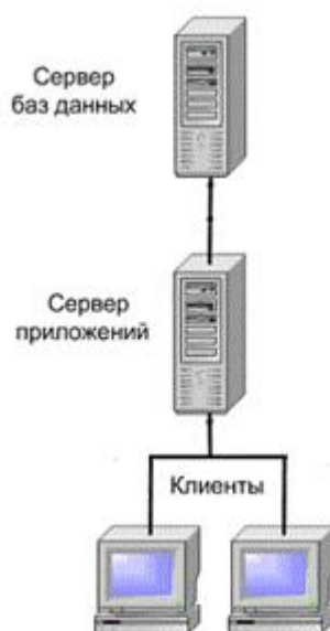
Рисунок 9 – Трехуровневая клиент-серверная архитектура
