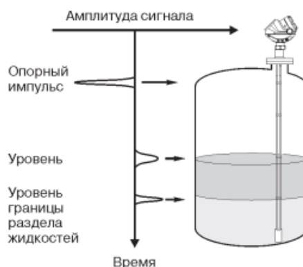
Рисунок 3 – Технология рефлектометрии с временным разрешением
