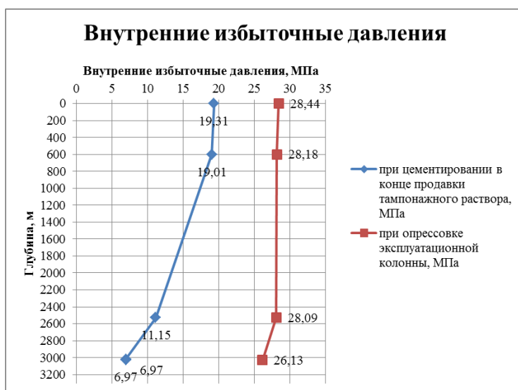
Рисунок 2.10 – Эпюра внутреннего избыточного давления
