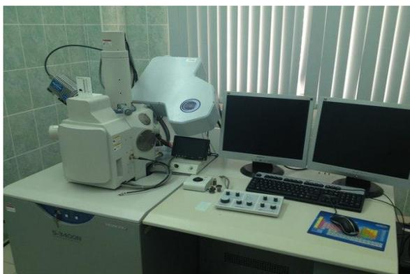
Рисунок 4.9 – Сканирующий электронный микроскоп HITACHI S-3400N
