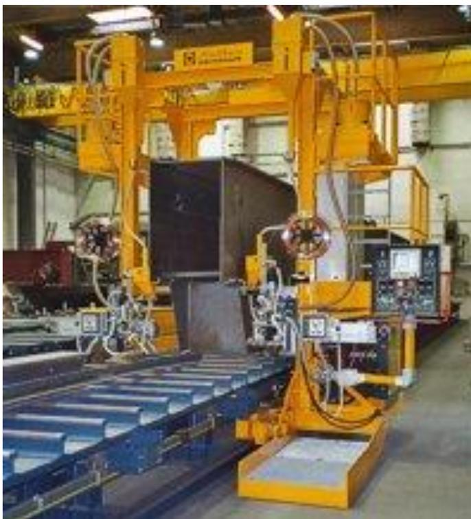
Рисунок 7 - Установка для сварки профилей и балок [9]
