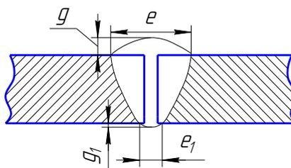
Рисунок 3 – Геометрические размеры шва
