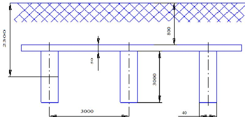
Рисунок 9 – Схема установки заземлителей
