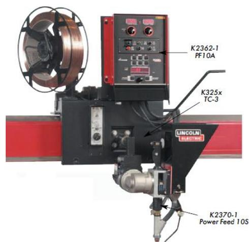
Рисунок 6 – Оборудование для сварки под слоем флюса
