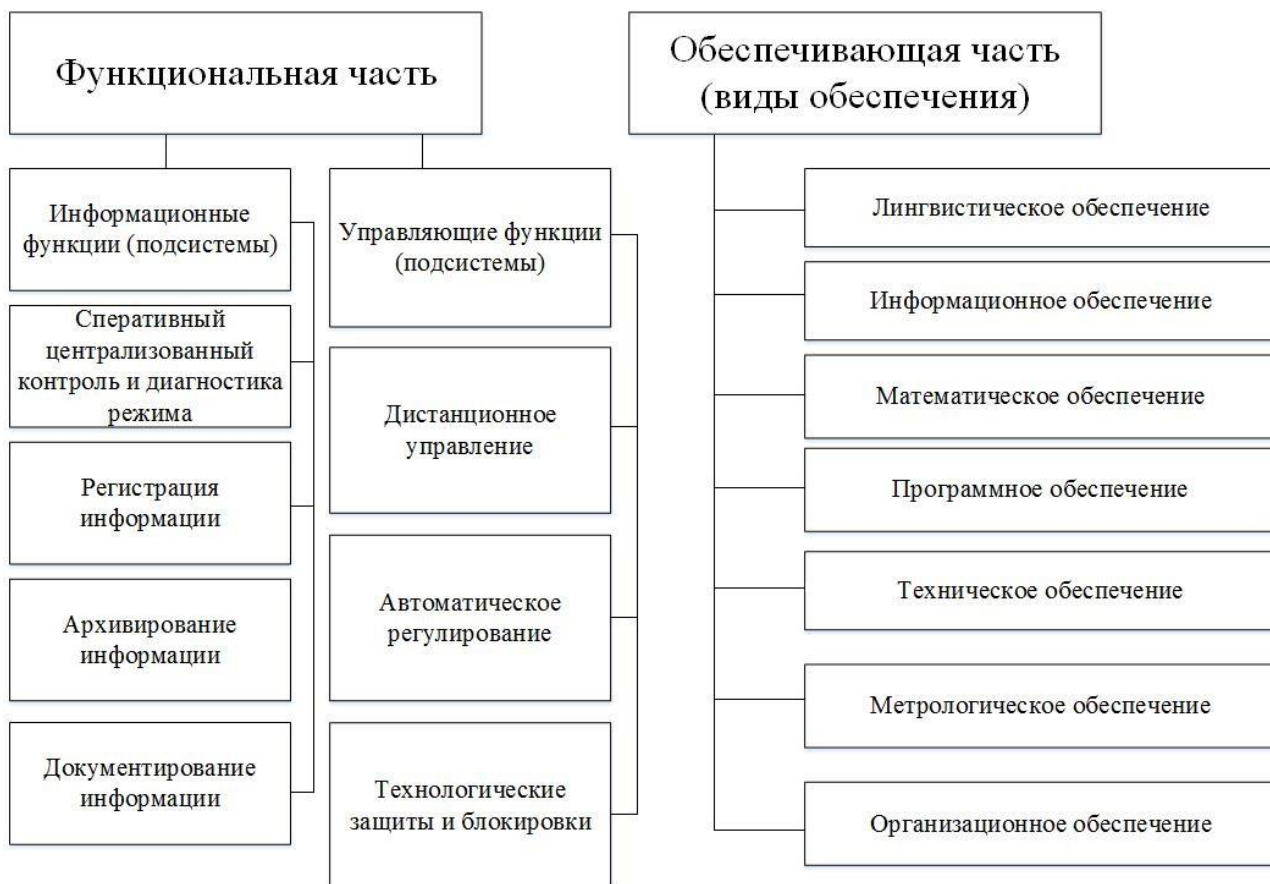
Рисунок 2.3 – Структура функциональных подсистем и видов обеспечения АСУ ТП
